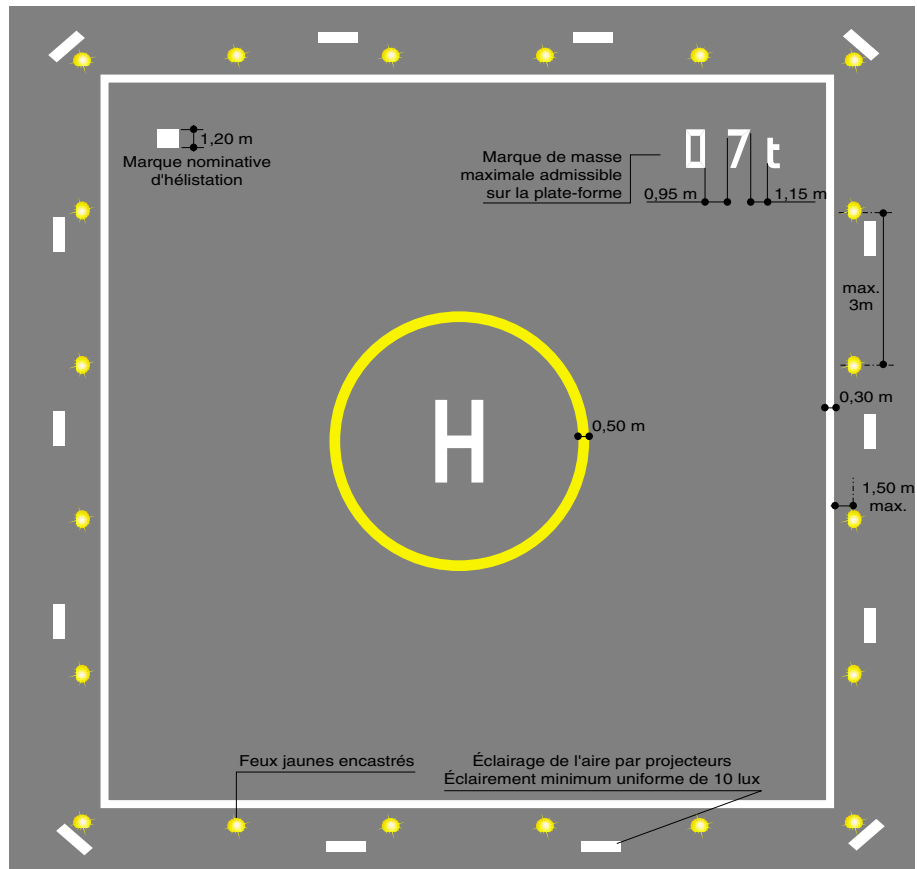
13-30 Balisage complet (lumineux et non lumineux) d'une hélistation en terrasse
