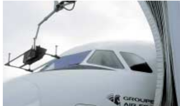
Poste de stationnement muni d'un système de guidage à barre de contact et détail de celle-ci
